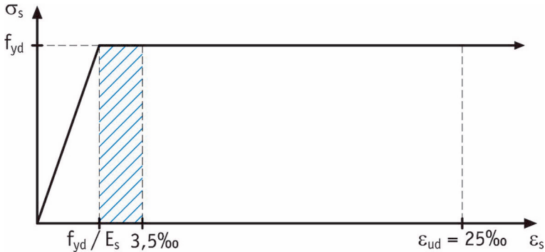
Abb. 35 zulässige Dehnung der Druckbewehrung für die Bemessungstafeln ( http://doi.org/10.33968/9783966270021-03-A-08 )
